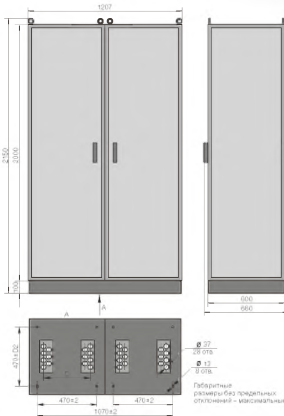
Габаритные и установочные размеры шкафа типа ШЭ2607 061
