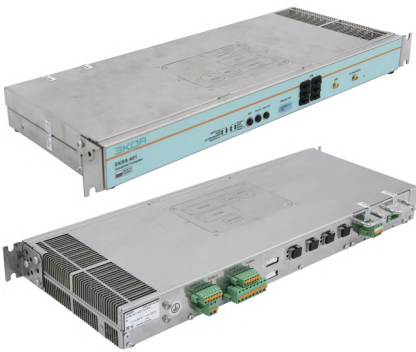
Рисунок 3 – Внешний вид УСПД «EKRA A01»
