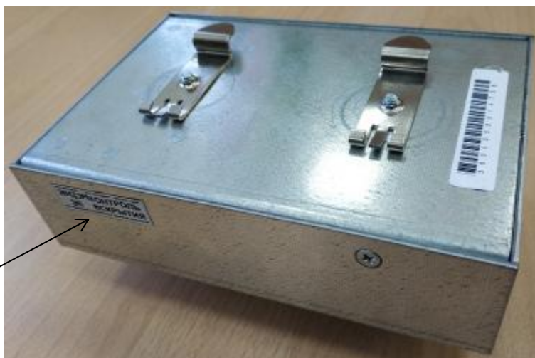
в) место пломбировки от несанкционированного доступа модулей модификации БЭ2005М-ТИ8
