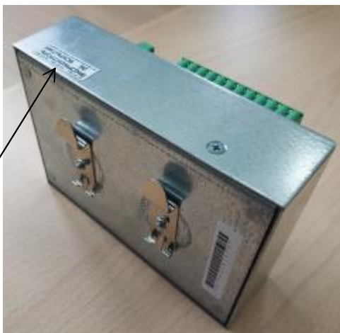
а) место пломбировки от несанкционированного доступа модулей модификации БЭ2005М-ИП
