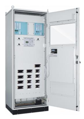
Комплект A2 реализует функции AУB, AПB, УРОВ, МТЗ с комбинированным пуском по напряжению стороны ВН от многократных КЗ, ТЗНП, защиты от непереключения фаз и защиты от неполнофазного режима. Обеспечивает прием сигналов от ГЗТ и ГЗ РПН.
